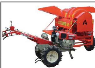
Power tiller operated Multi-crop Thresher (पावर टिलर अपरेटेड मल्टि क्रप थ्रेसर)
